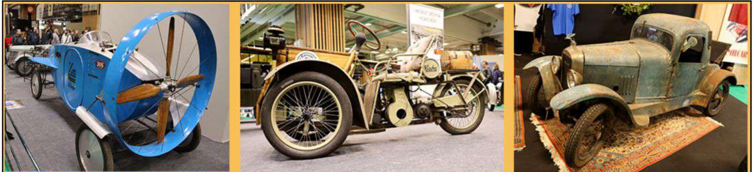
De gauche à droite: Marcel Leyat applique les principes de l'aviation à son véhicule et construit en 1919 cette Helica avec un bicylindre JAP de 1000 cc. Inventée par Georges Gauthier en 1925, une Auto Plume Cabri puis une "sortie de grange": une Amilcar CC de 1922
